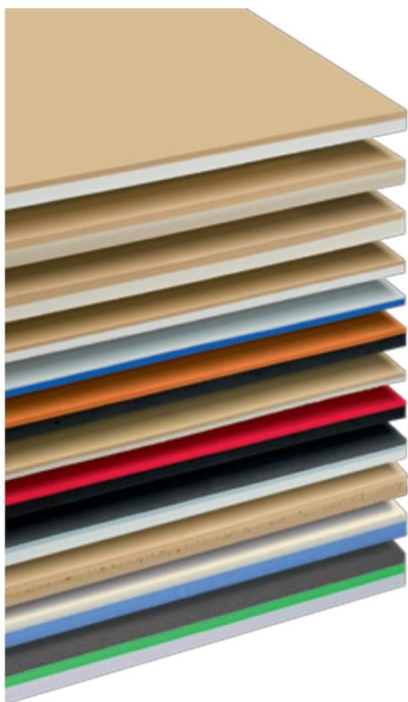
nora® Lunatec combi es un producto innovador en el campo de las planchas compuestas: Durante el proceso de fabricación se vulcanizan entre sí de dos a tres materiales diferentes, que ofrecen agarre seguro, sin necesidad de pegado.
