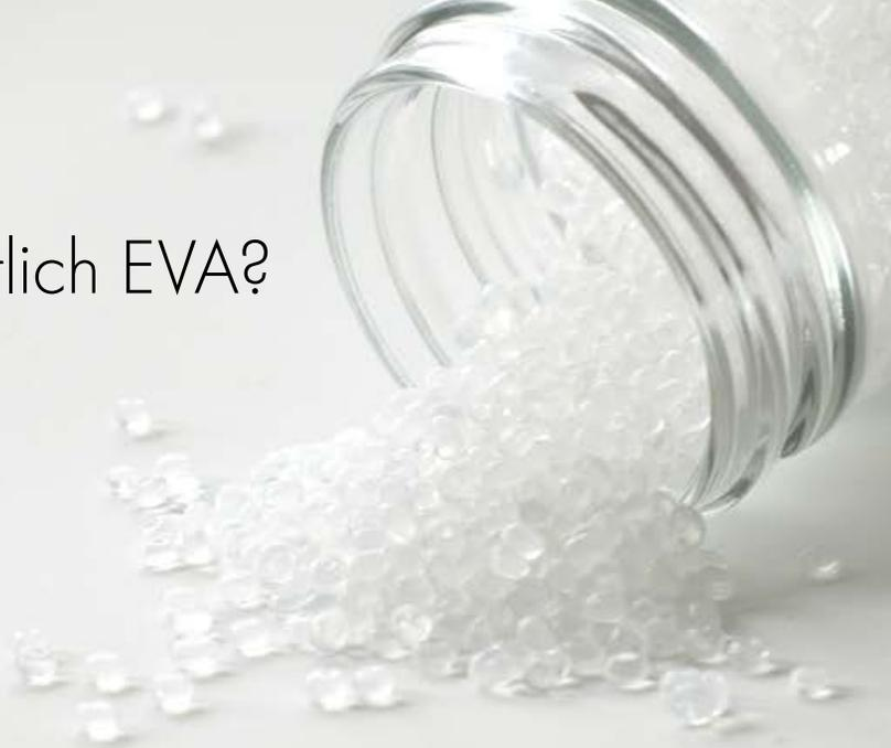
Der Rohstoff EVA (Ethylen-Vinyl-Acetat) ist ein Kunststoffgranulat, das es in verschiedenen Abstufungen im Vinyl-Acetatgehalt gibt, was unterschiedliche Eigenschaften mit sich bringt. Vulkanisiert und mit entsprechenden Treibmitteln, Farb- und Füllstoffen versehen, entsteht unter Hitze und Druck aus einem Rohling eine geschlossenzellige EVA-Leichtzellplatte. Zu einem solchen Schaum verarbeitet, ist EVA spezifisch leicht,
