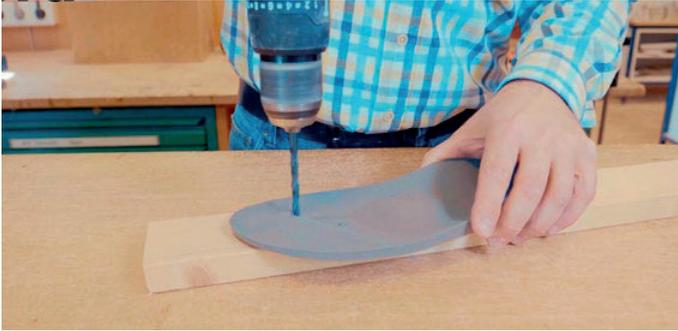
Anschließend wird das Loch zur Durchführung des Zehenstegs gebohrt. Alternativ kann hierfür auch ein Stanzeisen verwendet werden. Durch dieses Loch wird das Zehenstegband, doppelt aufeinander gelegt, hindurch gedrückt.
