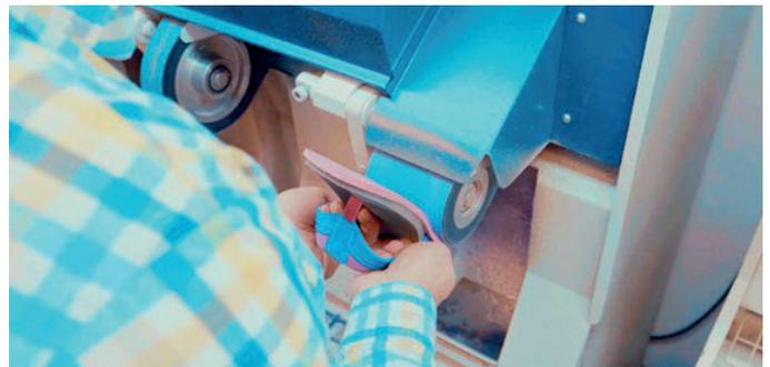
Nach dem Schleifen wird Lunasoft SL mit Klebstoff eingestrichen, um nach dem Ablüften das Sohlenmaterial Astrolight Delta ankleben zu können. Es empfiehlt sich erneut überstehendes Material abzuschneiden, um es anschließend besser in Form schleifen zu können. Und fertig ist die Zehenstegsandale mit Fußbett.
